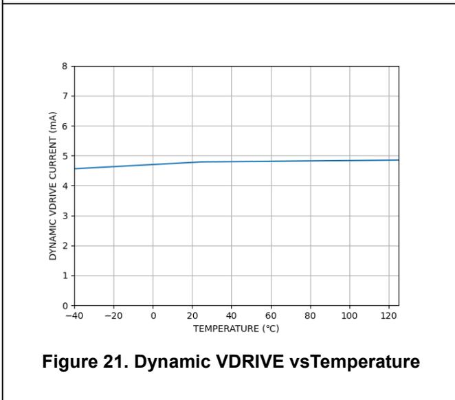
Figure 21. Dynamic VDRIVE vs Temperature
