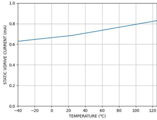
Figure 23. Static VDRIVE vs Temperature
